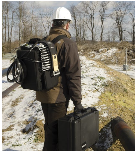
Система LRT транспортируется и управляется одним оператором.
