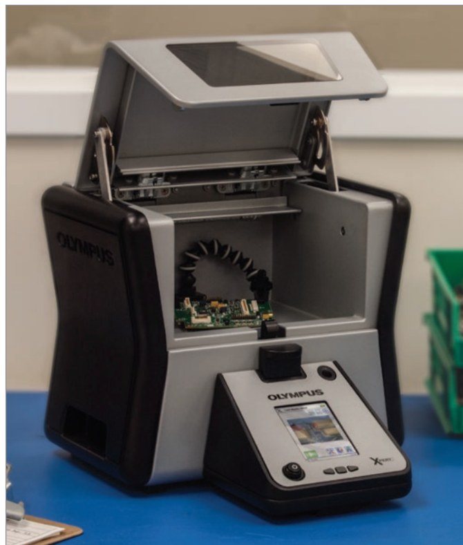
Образцы небольшого размера закрепите с помощью держателя.
