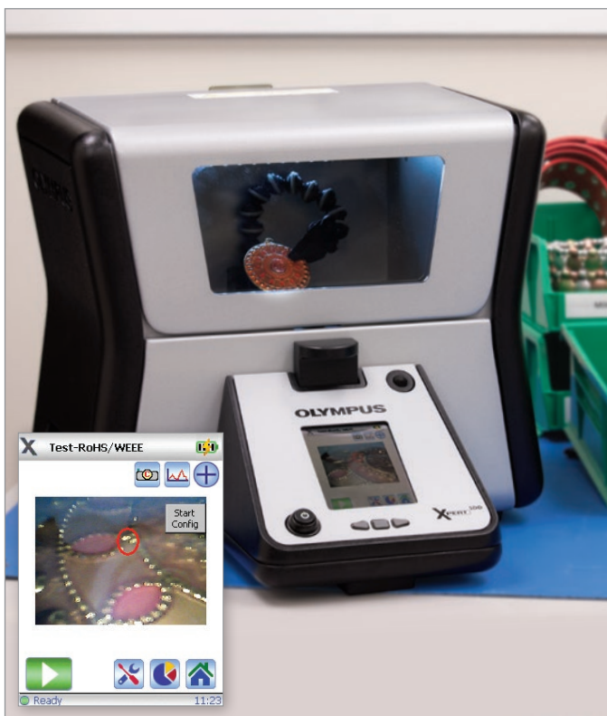
Коллиматор используется при анализе мелких предметов или определенных участков изделия.
