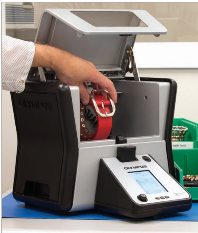
Хpert очень прост в использовании. Просто поместите объект на измерительное окно анализатора.
